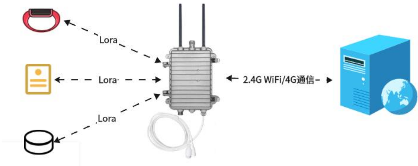
图 1-4 Lora 网关采集 Lora 传感器信息
