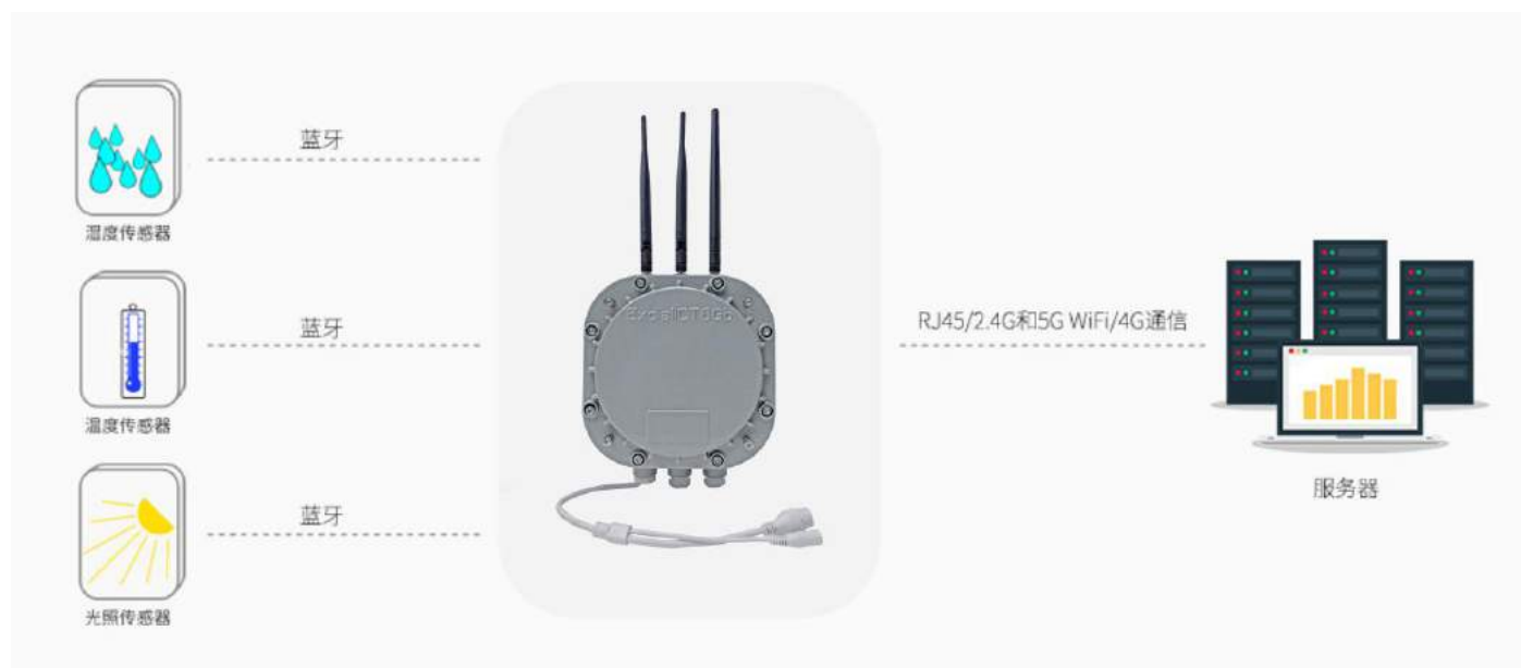
图 1.4 蓝牙网关采集蓝牙传感器信息
