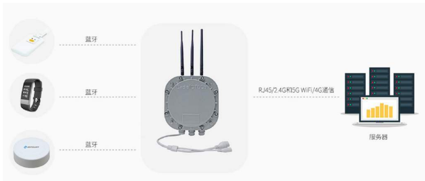
图 1.5 蓝牙网关采集蓝牙信标信号强度
