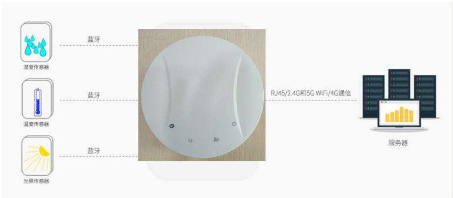
图 1.5.1 蓝牙网关采集蓝牙传感器信息
