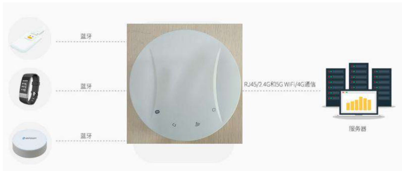
图 1.5.2 蓝牙网关采集蓝牙信标信号强度
