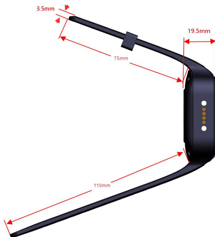
图 4-2 VDU1502-PBR 侧面尺寸 (±1mm)
